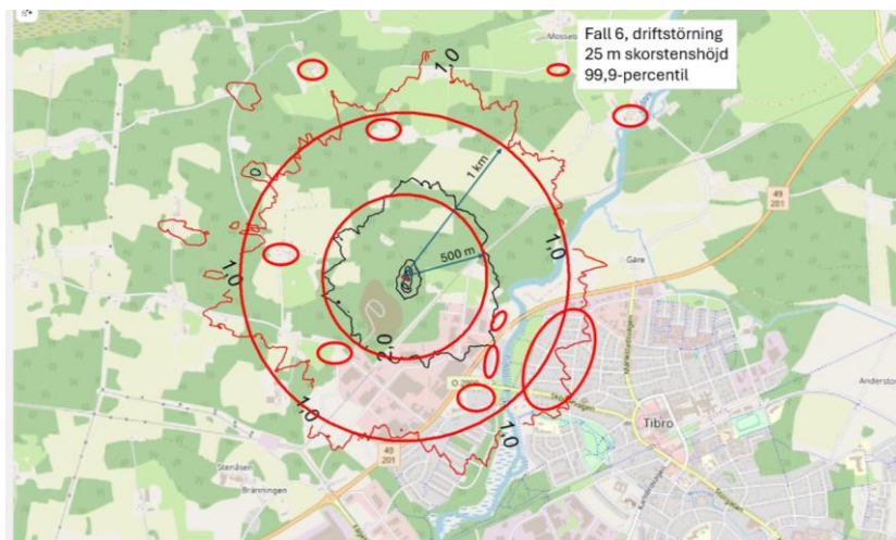
Figur 9. Spridningsbild för lukt, 99,9-percentilen vid modellerade förhållanden för driftstörningar motsvande tredubblade utsläpp enligt fall 6, 25 meters skorstenhöjd.
